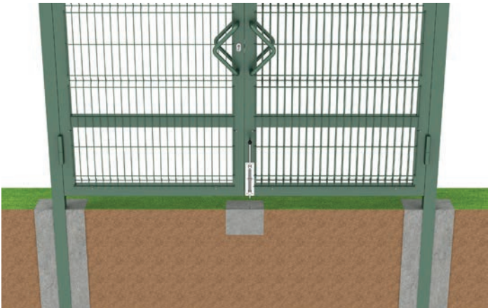
□ Монтаж с бетонированием столбов
